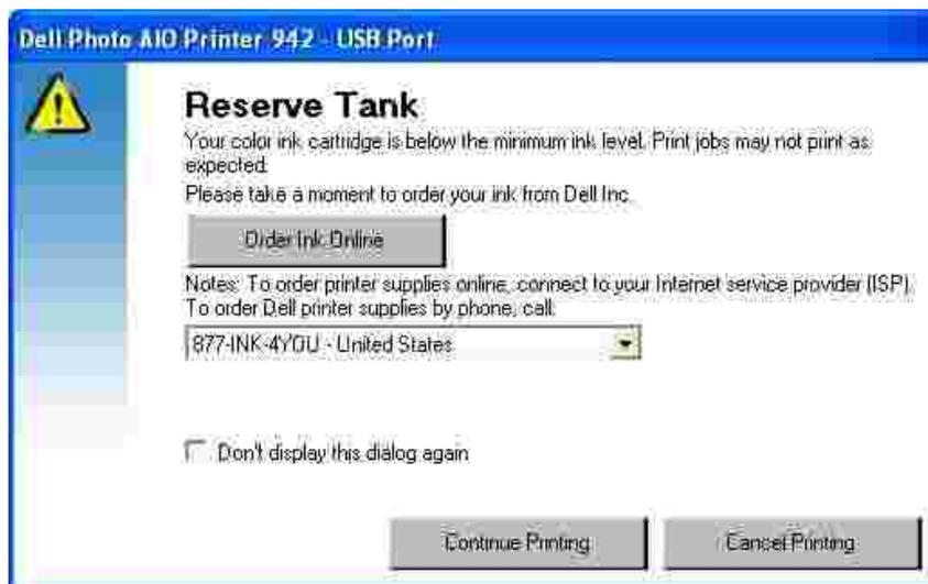
ブラックカートリッジがインク切れの場合、[印刷を完了]を選択してから[印刷続行]ボタンをクリックして、カラーカートリッジを使用して黒で印刷することができます。[印刷を続行]を選択して[印刷続行]をクリックすると、ブラックカートリッジを交換するか、Dellソリューションナビの[メンテナンス]タブからオプションをオフにするまで、すべての黒印刷に合成されたブラックが使用されます。インク切れのカートリッジが交換されるまで、[予備タンク]ダイアログは二度と表示されません。新しいカートリッジまたは別のカートリッジが取り付けられると、[印刷を完了]チェックボックスは自動的にオフになります。
