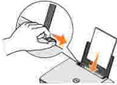
**※**：レターヘッドのある用紙の場合は、レターヘッドのある方をプリンタ側に向けて、印刷面が手前になるようにセットします。
